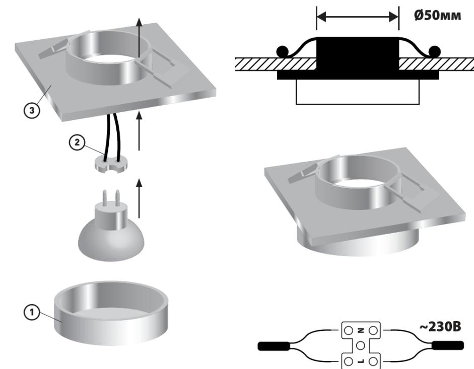
**Схема сборки для для светильников потолочных 52059 7, 52060 3, 52061 0, 52062 7**
